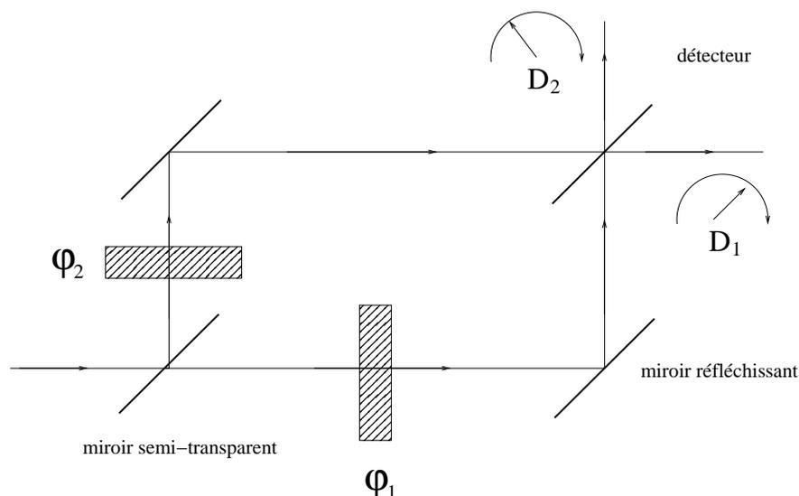
Une source de photons unique envoie un photon dans l'interféromètre. Le photon passe à travers un miroir semi-transparent, puis est déphasé par les déphaseurs  $e^{i\varphi_1}$  et  $e^{i\varphi_2}$ , puis est réfléchi par les miroirs réfléchissants et enfin passe à travers le dernier miroir semi-transparent. Le processus de mesure correspond à une détection dans les photo-détecteurs  $D_1$  et  $D_2$ .
