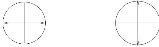
Figure 4.2: Orientations des polariseurs pour la préparation des photons dans la base Z .
