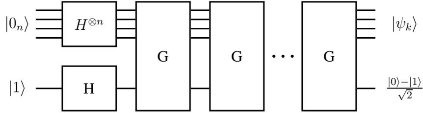
La profondeur (temps de calcul) du circuit est  $O(K)$  et sa largeur  $n + 1$ .
