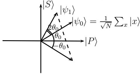
L'état réfléchi contient les solutions marquées par une phase -1. La prochaine étape consiste en une réflexion par rapport à  $|\psi\rangle$ , ce qui nous amène sur  $|\psi_1\rangle$  (voir figure). On notera deux points importants :
